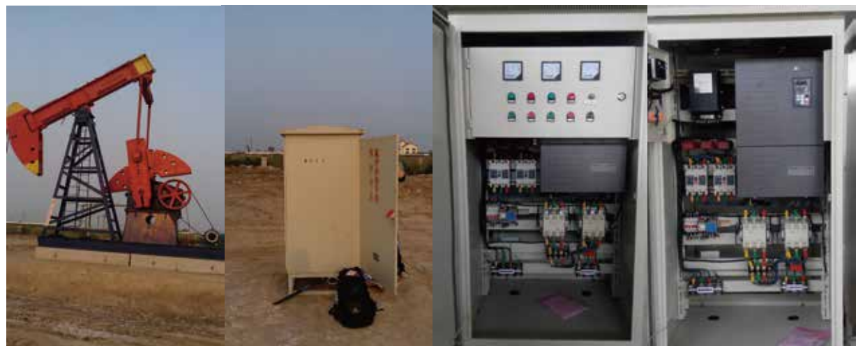
易驱ED3100系列变频器在油田开采注水井上的应用
