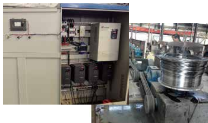
易驱变频器在多级直进式拉丝机上的应用
