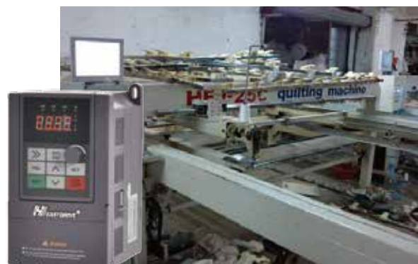
易驱变频器在特种设备绕线机的应用
