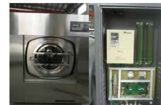
易驱变频器在江苏某工业洗衣厂上的应用
