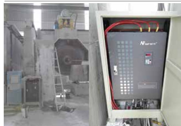
易驱CV3100变频器在切石机上的应用
