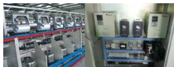
CV3100变频器在倍捻机上的应用
