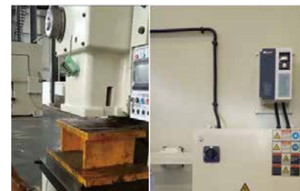
M200变频器在数控车床上的应用
