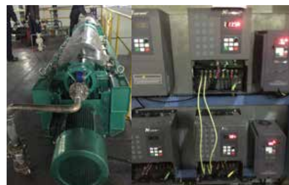
CV3100变频器在卧式螺旋离心机上的应用
