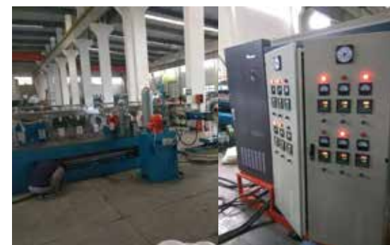
CV3100-280KW变频器在发泡机设备上的应用
